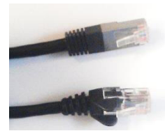
Abgeschirmter Stecker oben, ungeschirmter Stecker unten
